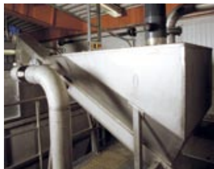
Exemple d'installation du séparateur Läckeby Products SA 260-50.
