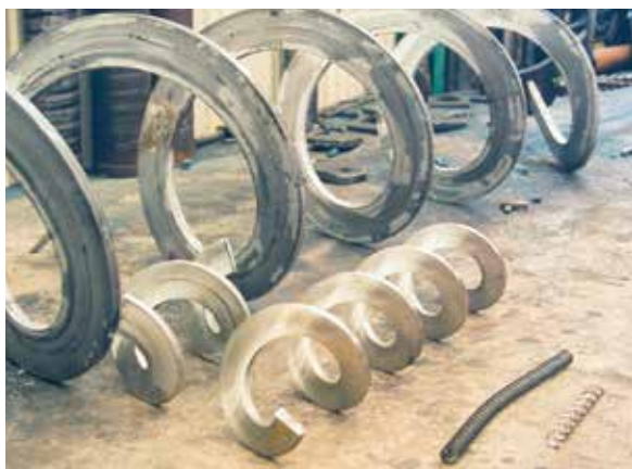
Rostfria spiraler med varierande diameter och stigning.
