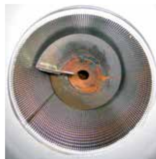
Invändig vy över pressrör i Wedge Weir och spiral i svart material S355J0.
