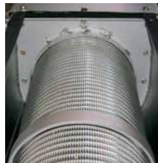
Läckeby Products skruvpress är utrustad med inspektionsslucka över pressenheten och utbytbart pressrör.
