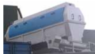
Un compacteur à vis WSP-260 combiné à un tamis rotatif Roto-Sieve® RS-416 garantit une séparation optimale des refus de dégrillage.
