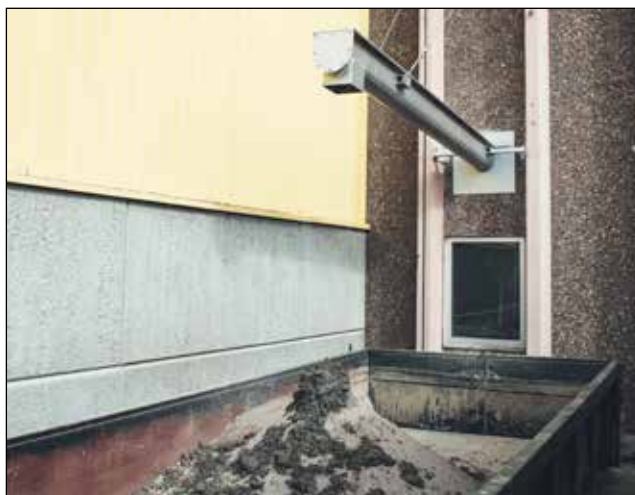
Skruvtransportör som transporterar väl avvattnad sand till lastväxlarflaket utanför produktionslokalen före deponi/återvinning.
